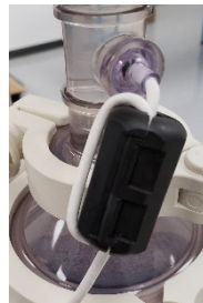
Abbildung 3. Am Fließweg-Drucksensor installierte Ferritperle
